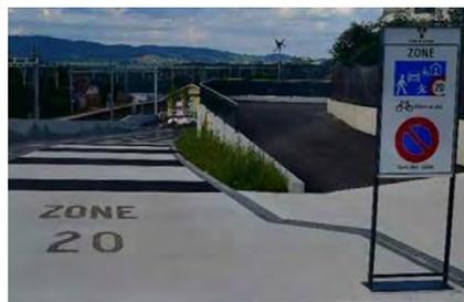
Le marquage au sol, dont la première fonction est celle de constituer un seuil (bandes larges au sol) aux 3 portes d'entrée de la place et d'inciter, visuellement, l'automobiliste à ralentir car il pénètre sur une place où le piéton est prioritaire. Les géométries au sol appuient et prolongent les lignes de la Fontaine, de l'Espace 2 roues et relient l'escalier du parc du Clédard à la zone des commerces, lesquelles viennent tisser des liens avec les bancs.
